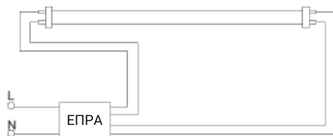
Світильник з ЕПРА до заміни
