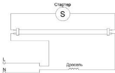
Світильник з ЕмПРА до заміни
