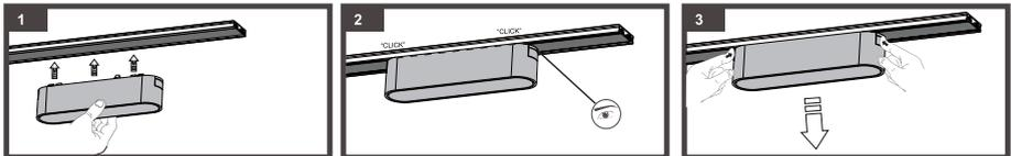
4.3 Піднесіть світильник або його адаптер, якщо він є окремим, до шини, вирівняйте паралельно до неї та вертикально притисніть (мал.1). В момент притиснення слідкуйте, щоб відбулося характерне легке клацання фіксаторів з обох кінців адаптера світильника, та його фінальне розташування було рівно паралельним до шини (мал.2).
